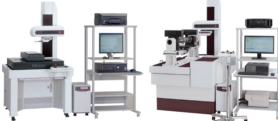
SV-3000CNC (Unidade de medição inclinável + mesa Y)
